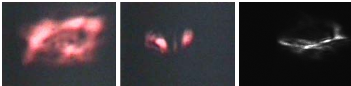
Рис. 1. Распределение интенсивности для пучка с высокой пространственной когерентностью (слева), «бинарного пучка» (центр) и пучка с низкой степенью когерентности (справа)
